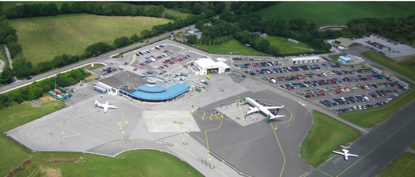
Proyecto de nuevo diseño de plataforma para el aeropuerto de Kerry (Irlanda) que consistió en la optimización de la plataforma existente con la reubicación de los puestos de estacionamiento de las aeronaves.
