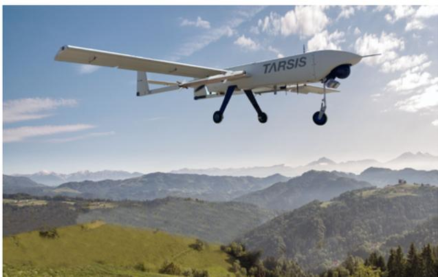
TARSIS-W es un Sistema UAS Clase I NATO con capacidad para integrar dos lanzadores de micromisiles de 50 mm de calibre bajo cada semiala, cada lanzador puede albergar hasta 2 micromisiles guiados por láser semiactivo con un alcance de 4 km en función de la altitud de disparo. Además, incluye un Sistema de Gestión de Armamento integrado con la Estación de Control de Tierra para operar la munición de forma remota y segura.
