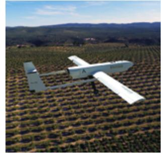
Las soluciones TARSIS-ISR cuentan con tecnología ATOL (Automatic Take Off and Landing), un sistema de control automatizado para todas las fases de vuelo. Además pueden integrar otras múltiples opciones: enlace satelital de respaldo, recuperación de emergencia con paracaídas, sensores espectrales, sensores topográficos, etc.
